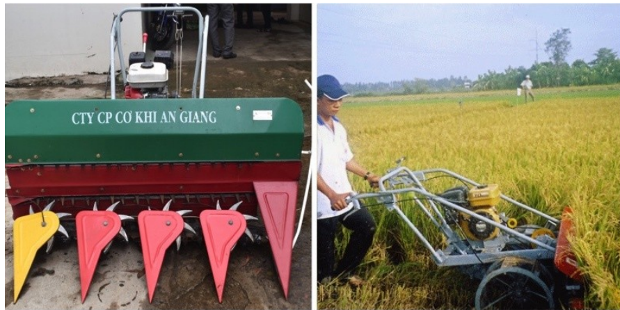
Máy gặt lúa xếp dẫy GX120 được thiết kế và chế tạo tại Công ty cổ phần Cơ Khí An Giang
